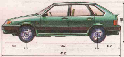
Рис. 1.1б. Габаритные размеры (справочные) автомобиля ВАЗ-2114
