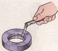
Рис. 2.40. Проверка зазора в замке колец
