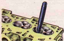
Рис. 2.57. Выпрессовка направляющих втулок оправкой А. 60153/ R
