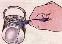
Рис. 2.39. Проверка зазора между поршневыми кольцами и канавками
